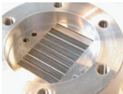
Figuur 4a Microreactor voor de verbranding van hydrazine, een raketbrandstof (groep van Prof. Schouten).
