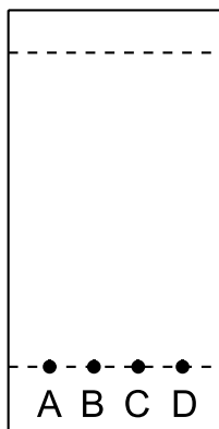
Figuur 1: Voorbeeld van een TLC- plaat met monsterspots.
